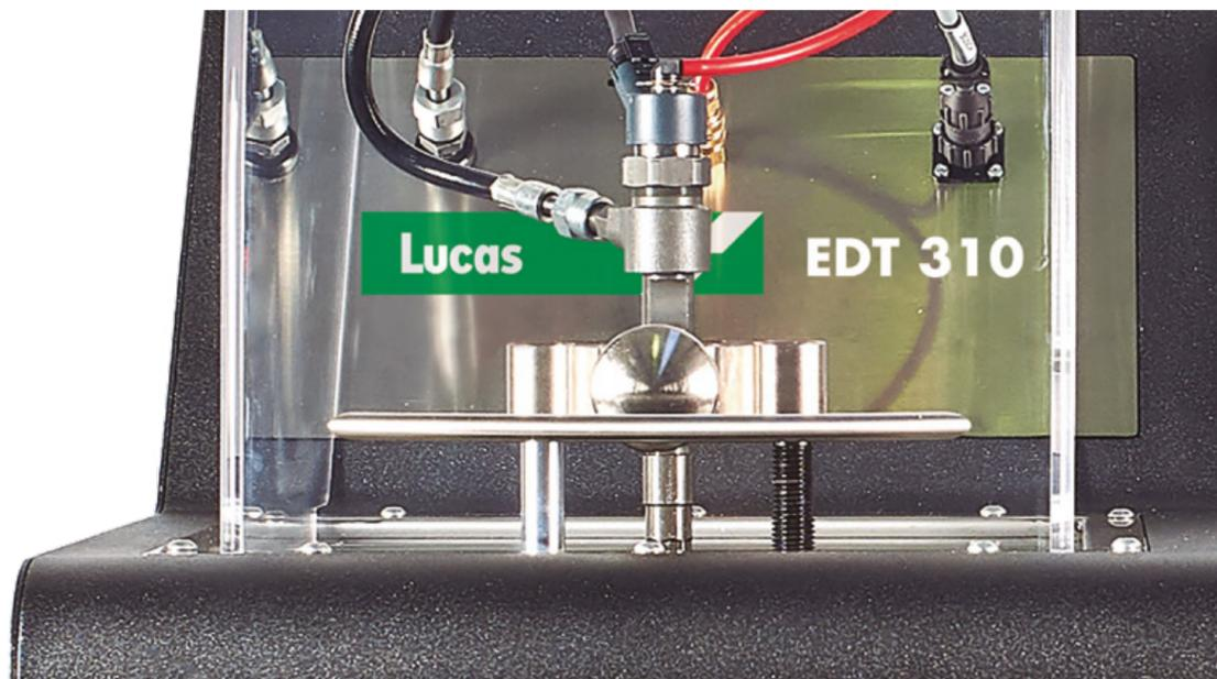
El diseño moderno del banco de pruebas permite al especialista en sistemas diésel verificar eficazmente cualquier inyector Common Rail de todas las marcas, incluyendo los sistemas piezoeléctricos.
